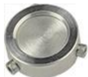
EM-Tec F13 フラットディスクホルダー Ø13mm ピン
